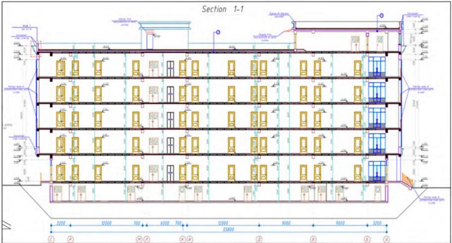
Рисунок 8: Секционный (с подвалом) вид здания общежития
